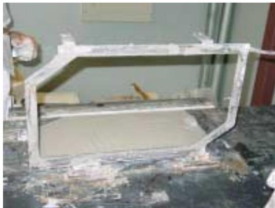
**FIGURA 5.** Telha após a moldagem em mesa vibratória.
