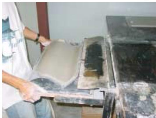
**FIGURA 6.** Retirada da telha e acondicionamento em fôrma própria.
