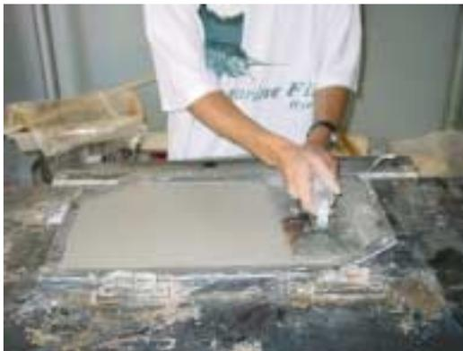
**FIGURA 4.** Moldagem da telha em mesa vibratória.
