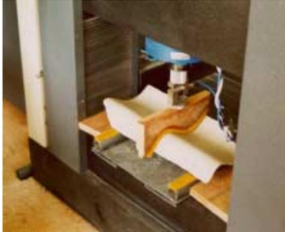
**FIGURA 8.** Teste de flexão de uma telha.
