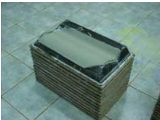
**FIGURA 7.** Pilha de fôrmas com telhas.
